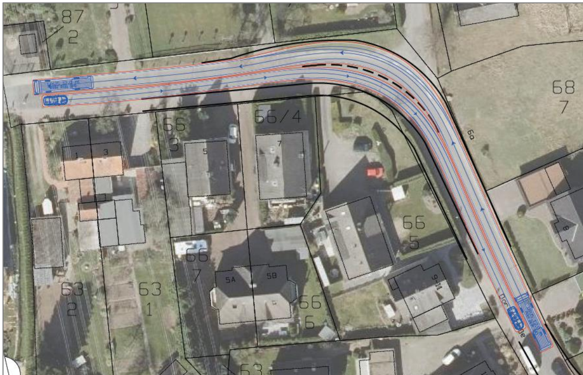
Abbildung 1.6: Schleppkurve - Kurve Nord (Bus 12 m 25 km/h, Pkw 30 km/h)
